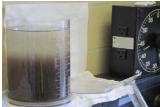
شكل رقم (11) يوضح بطئ ترسيب الحمأة
