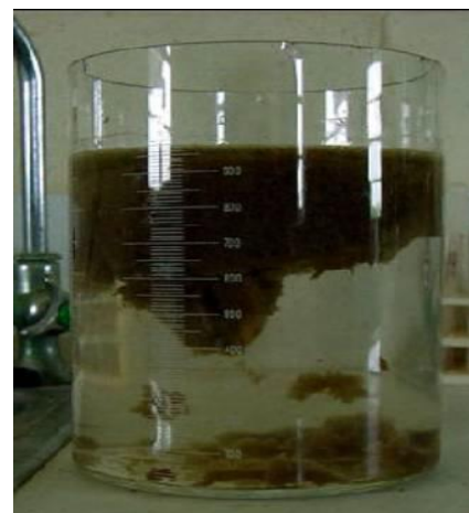
شكل رقم (6) وجود فقاعات غاز النيتروجين بالحمأة وطفوها على السطح
