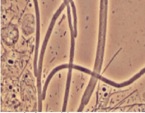
Sphaerotilus natans ينمو في الحماة بأحواض التهوية نتيجة انخفاض تركيز الأكسجين الذائب.
