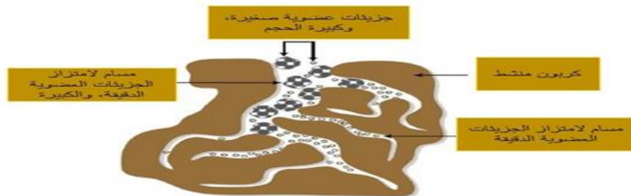
شكل 12 : عملية الإمتزاز على الكربون النشط
