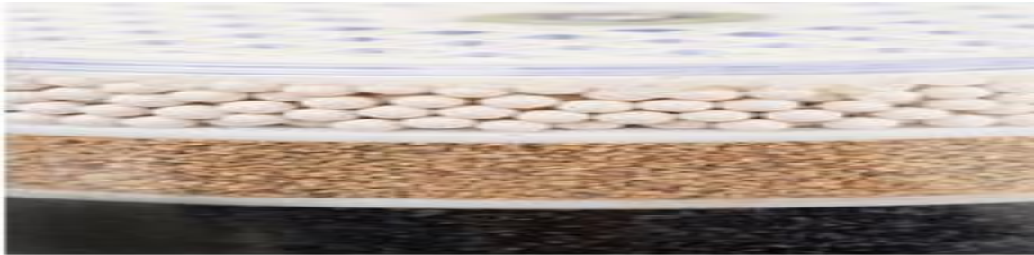
الشكل 2: شكل خليط أوساط الترشيح في المرشحات
