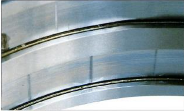
تشوه في المجرى الداخلية لكرسى زاوى نتيجة لزيادة نتيجة لضعف سماح الشحط على العمود
